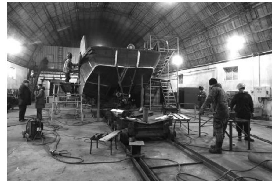
рнейшем зале, посередине которого находился судовой корпус. Справа от него - на полу - новая надстройка этого плавсредства. Время от времени все части будущего рыбацкого судна (РБ-80) освещались сполохами электросварки и рассыпающимися искрами от работающего резака «болгарки». Внутри его остова два слесаря устанавливали новый двигатель. Ряд других специалистов занимался прокладкой судовых коммуникаций. Стало понятно: рождение нового «парохода» остаётся ждать недолго.
